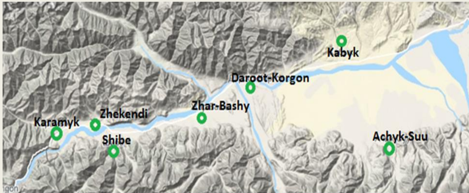
Населенные пункты проведенные сейсмические записи (микротреморы) на определение V_s30 .
